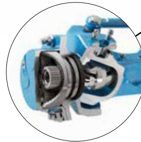
Planetenuntersetzung und Ölbadbremsen an allen 4 Rädern
